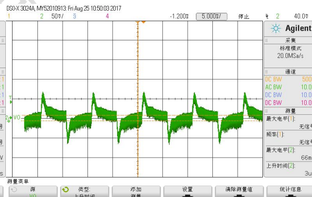
图 10 50%-75%-50%Io 动态负载 (300VAC)
