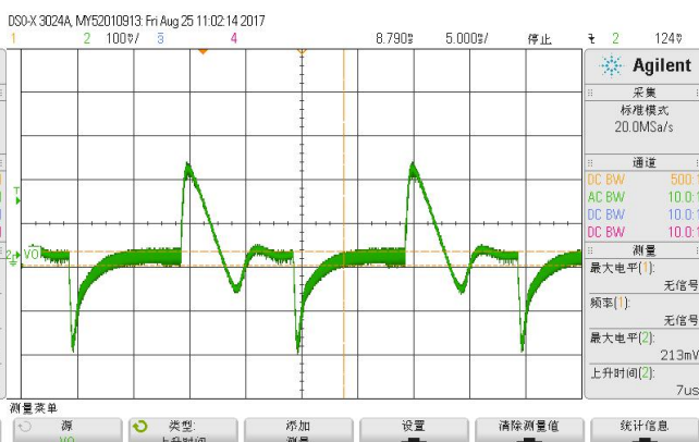
图 12 10%-100%-10%Io 动态负载 (300VAC)
