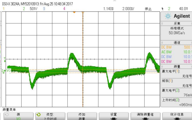
图 8 25%-50%-25%Io 动态负载 (300VAC)
