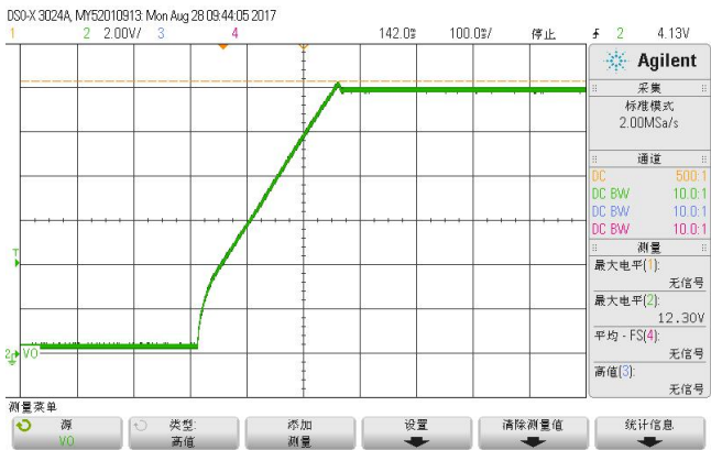
图 17 空载带 5200uF 电容启机 (85VAC)
