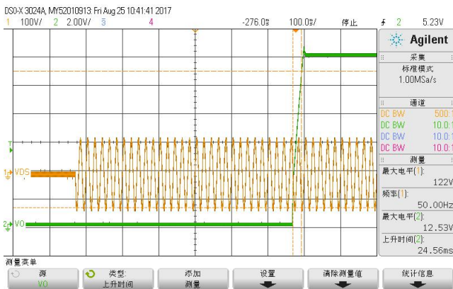
图 13 开机波形，黄：VIN，绿：Vo（85VAC）
