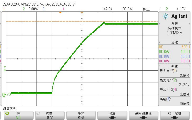
图 18 满载带 5200uF 电容启机 (85VAC)
