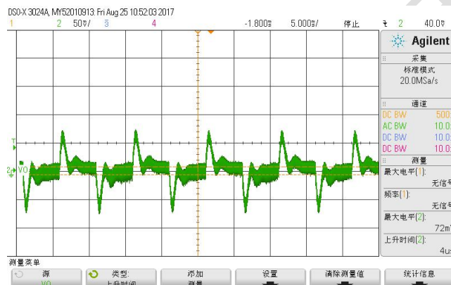
图 9 50%-75%-50%Io 动态负载 (85VAC)
