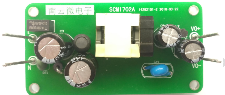
图 1 基于 SCM1702A 的 AC-DC 隔离电源应用方案
