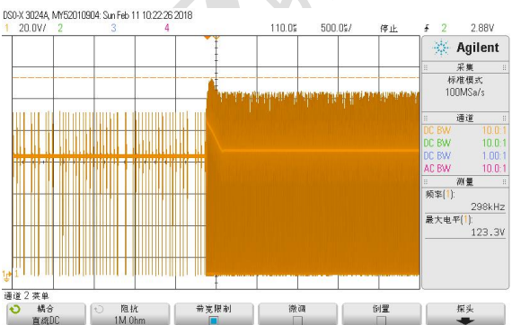
图 37 空载-短路 VDS 波形
