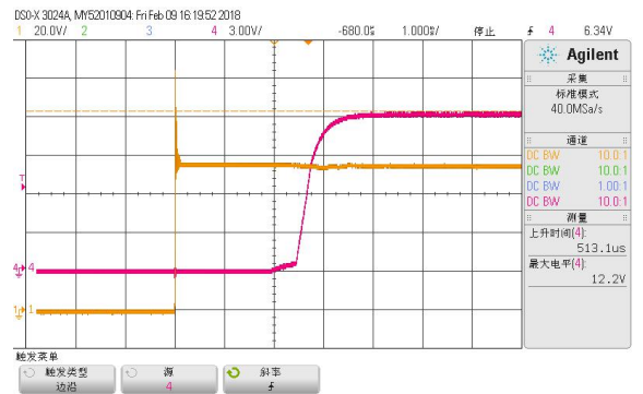
图 20 开机波形, 黄: VIN, 红: Vo (75VDC)
