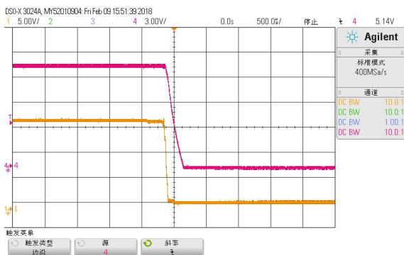
图 21 关机波形, 黄: VIN, 红: Vo (18VDC)
