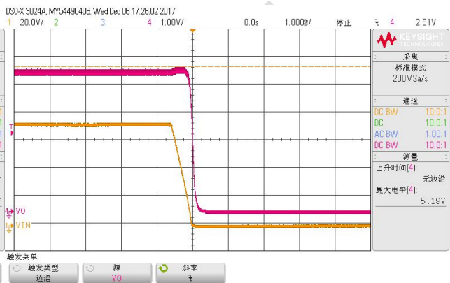
图 16 关机波形，黄：VIN，红：Vo（75VDC）
