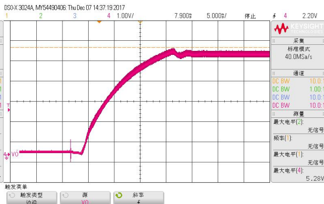
图 18 满载带 10000uF 电容启机（75VDC）
