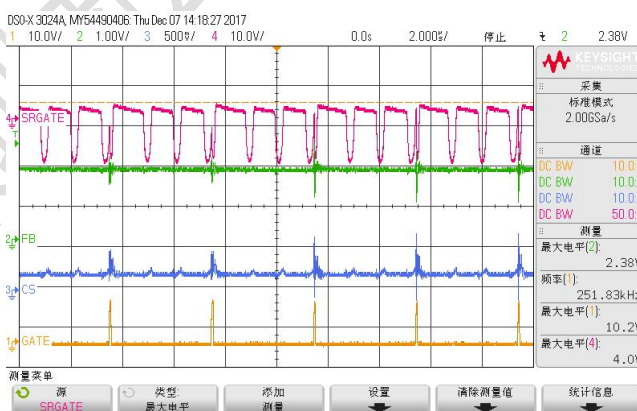
图 21 75VDC 空载工作波形
