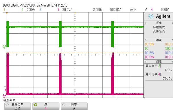
图 25 过流保护波形 (264VAC)
