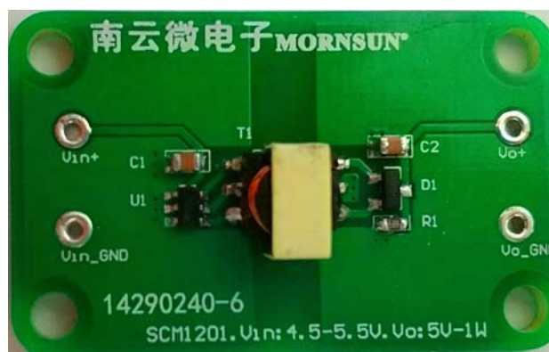
图 1 基于 SCM1201A 的 DC/DC 隔离电源应用方案
